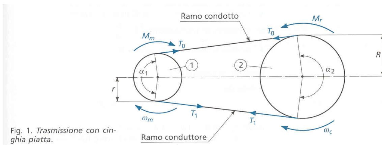
Fig. 1. Trasmissione con cinghia patta.
